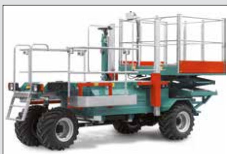
Piattaforma speciale per l'installazione e la manutenzione delle reti Hebebühne für Arbeiten an den Netzen
